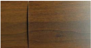
1000小时 Q-sun 加速老化对比样件
